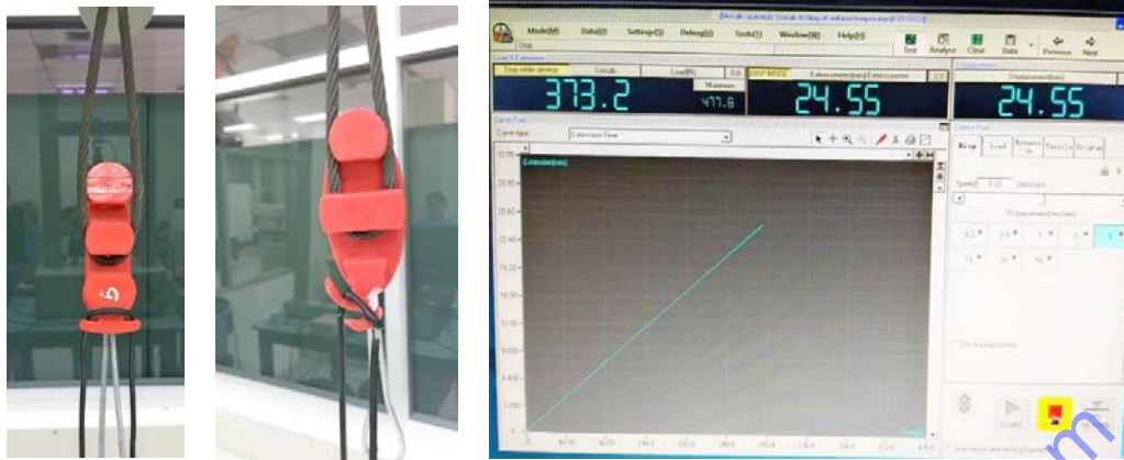
ภาพประกอบที่ 21. ทดสอบการรับแรงดึงของแกนพันและร่องลีดคสายสะพานฯ
